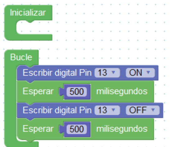
Parpadeo del led 13 con retardo de 500 ms
