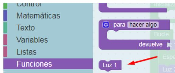
Es importante destacar que las funciones no se definen dentro del “Bucle”. Se crean fuera y luego se insertan dentro en los momentos en los que queramos que se ejecuten.
