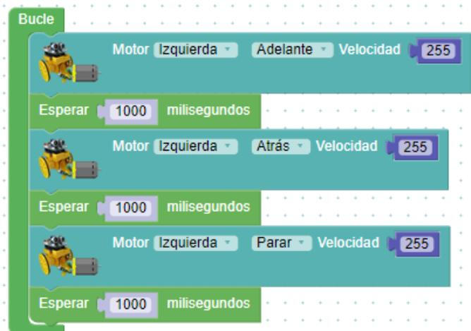
En total podemos hacer funcionar cualquiera de los dos motores, en cualquiera de los sentidos, parar e incluso podemos ajustar la velocidad de rotación.
