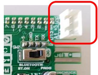
Por ejemplo, una buena idea es programar, por primera vez, el Ángulo a 0° para descubrir el punto de origen y a partir de aquí montar alguno de los accesorios que vienen con el servo para poder visualizar la rotación del eje. Vamos a volver a usar el conector “Zócalo sensor externo” que utiliza la salida A1.
