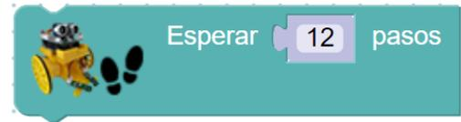
Se puede comprobar experimentalmente que, aproximadamente, para realizar un giro de 90 grados hacia la derecha, la rueda izquierda tiene que moverse 4 pasos (pasan 4 radios de la rueda por delante del sensor óptico). De esta forma le podemos decir a nuestro robot que gire 90 grados, 180 grados, etc.
