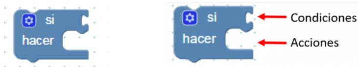
En el apartado de condiciones se pueden introducir multitud de factores: estado de sensores, (analógicos o digitales), comparaciones, igualdades, operaciones matemáticas, etc.
