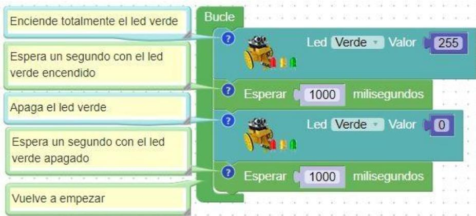
Con este programa conseguimos que el led verde parpadee con una frecuencia de 1 segundo de encendido y apagado. Puedes probar a cambiar tiempos e introducir más leds, así como a variar su intensidad de brillo.
