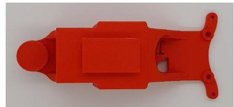
4.-Montamos la placa Arduino y el Shield Imagina Arduino a la caja de soporte de la placa con 3 tornillos de estrella de 2,9x6,5mm.
