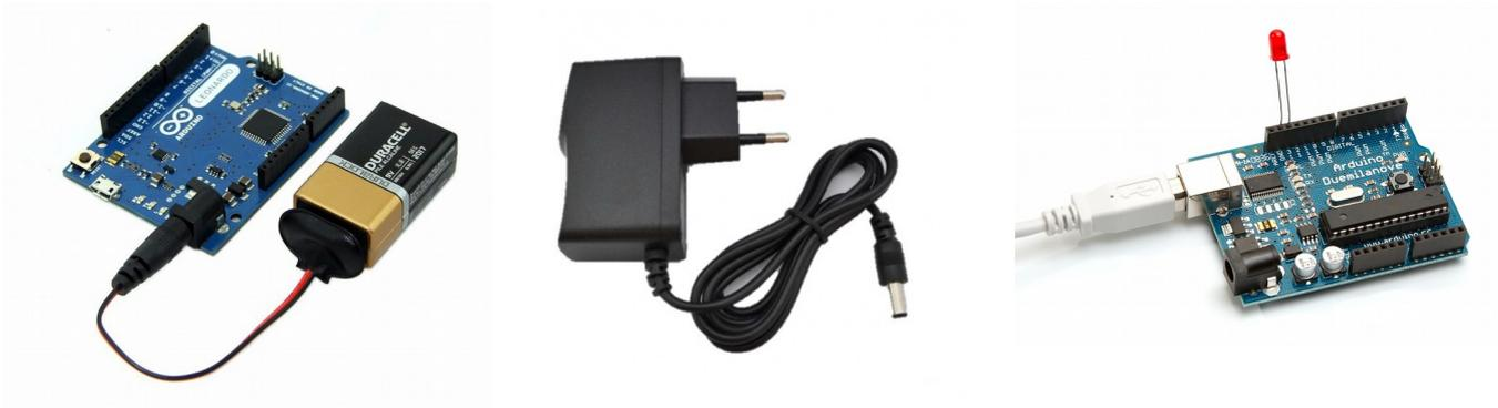
Ejemplo de conexión de la alimentación suministrada en los pines 5v y GND de Arduino para utilizarlo en una placa de prototipos donde conectar sensores, actuadores, etc.:
