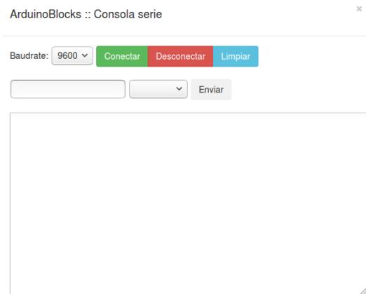
La conexión serie de Arduino está accesible en los pines 0 (RX) y 1 (TX), internamente estos pines están conectados al chip que gestiona el USB, en caso de usar la comunicación serie con otros dispositivos conectados a los pines 0 y 1 se deberá desconectar el USB para evitar que se mezclen los datos y no funcione la comunicación.
