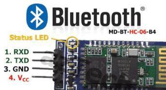
La conexión con la placa Arduino utiliza 2 pines, uno para RX y otro para TX. ArduinoBlocks implementa un puerto serie por software para comunicar con el módulo Bluetooth y así no interferir con el puerto serie integrado en Arduino UNO (pines 0 y 1) utilizado también para la programación del microcontrolador de Arduino.
